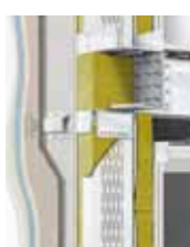
Enojna podkonstrukcija, s prezračevalnim kanalom – perforirani profili
