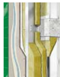
Dvojna podkonstrukcija z neprekinjenimi profili
