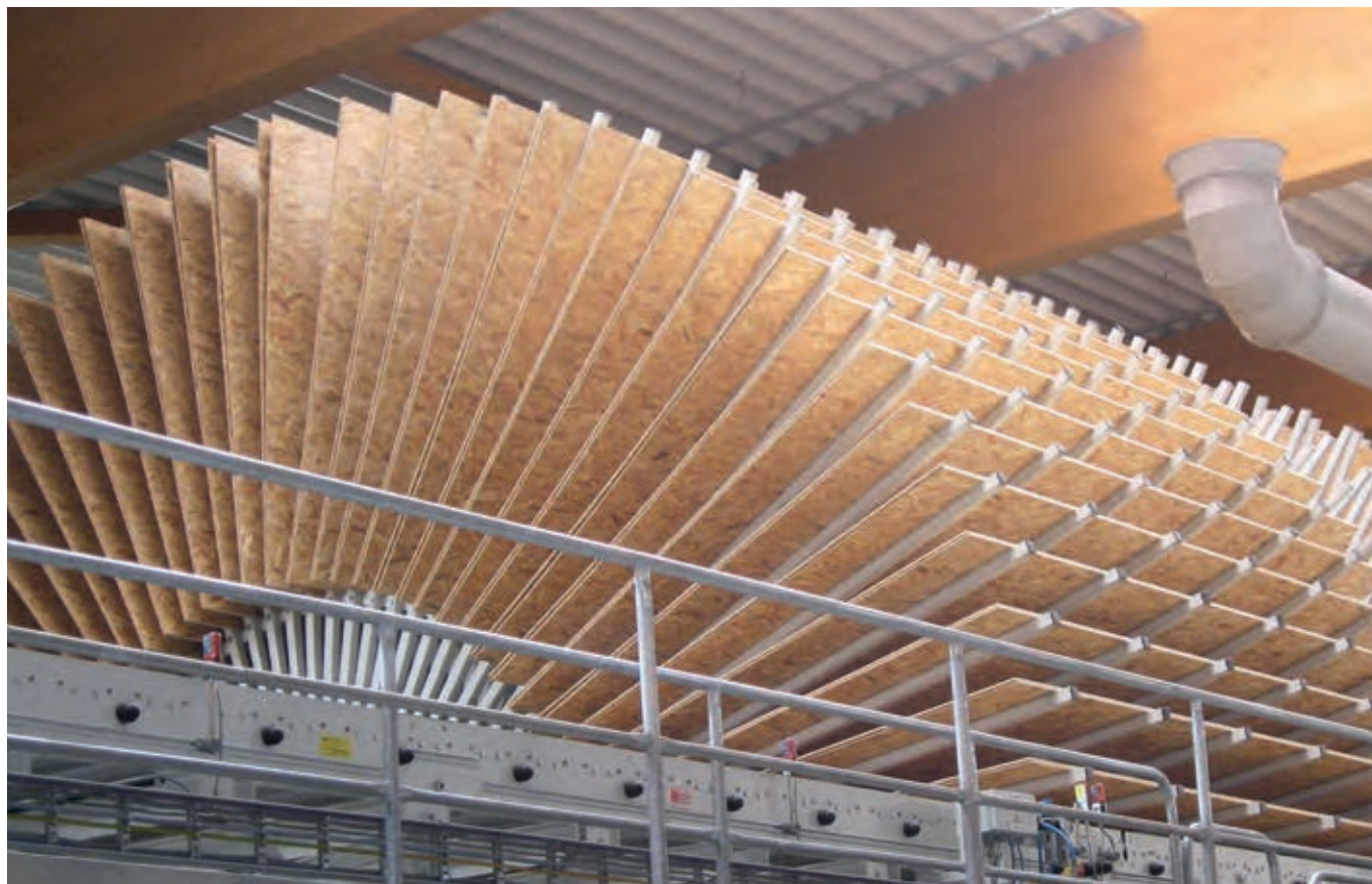
Visoki standardi kakovosti: OSB plošče v rotacijskem sistemu za ohlajanje v EGGER tovarni.
