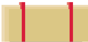
Za aklimatizacijo na gradbišču: plošče ločene z letvami.
