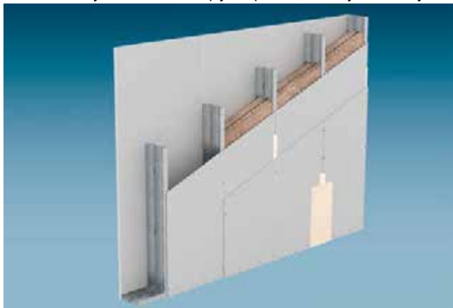
W115W.si Dvojna zvočno odklopljena podkonstrukcija - dvoslojna obloga + 5. sloj plošč
