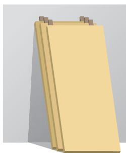
Za aklimatizacijo na konstrukcijski strani: Plošče namestite z letvami
