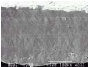
Prerez membrane = funkcionalna plast Tyvek® Solid 220 \mu\text{m}
